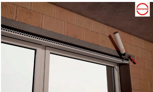
05 SLP-Laibungsplatten auf Maß schneiden. Zuerst die Platte im Sturzbereich in das Einfassprofil einschieben, leicht wegklappen und im Kastenverfahren mit SLP-Systemschaum ausschäumen. Danach ausrichten und mit Klebeband an der Wand fixieren.
